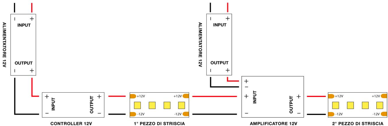
L'uso dell'amplificatore di segnale e di tensione è indispensabile per l'installazione di strisce LED superiori ai 10 mt. Permette di avere uniformità sulla luminosità e tonalità di Luce. Inoltre offre una maggiore durabilità alle bobine LED. Ogni amplificatore deve essere alimentato a sua volta, le dimensioni di potenza dell'alimentatore dipendono dalla potenza di consumo della striscia.
